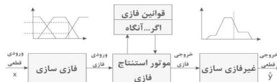
شکل ۲- ساختار کلی سیستم استنتاج فازی
